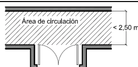
Figura 1.1 Disposición de puertas laterales a vías de circulación En proyecto:
